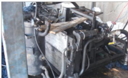
Fig. 1: Sistema d'aria compressa trascurato
