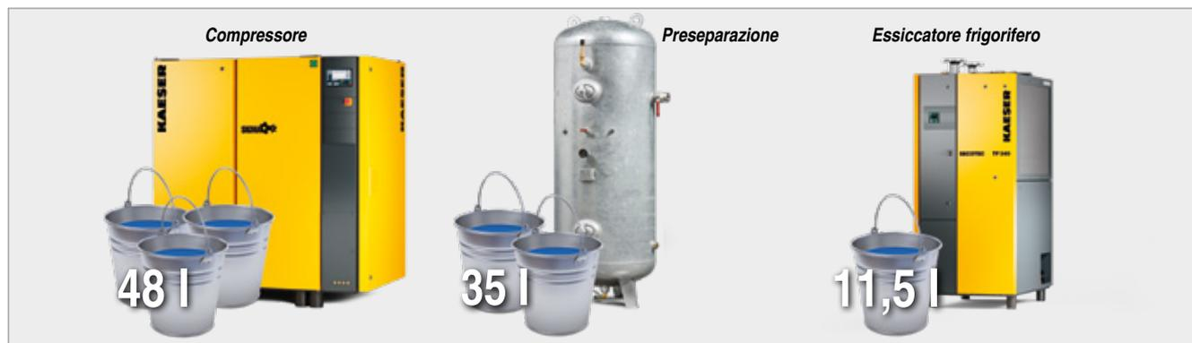
Fig. 1: Nelle fasi di produzione, stoccaggio e trattamento dell'aria compressa si genera la condensa (dati relativi a 10 m<sup>3</sup>/min, 10 bar (a), 8 h, 60 % U<sub>rel</sub> e 20 °C)
