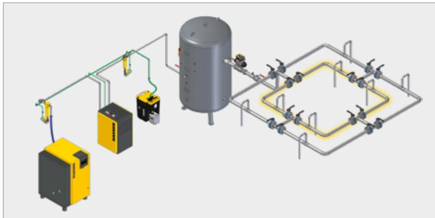
Fig. 1: Risanamento di una linea d'aria mediante installazione di una seconda condotta anulare
