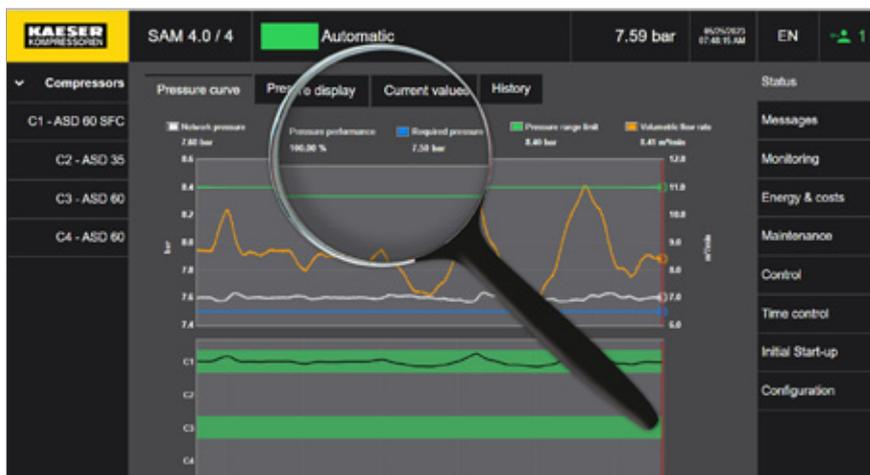
Fig. 5b: Curve di portata e pressione con monitoraggio del profilo di pressione
