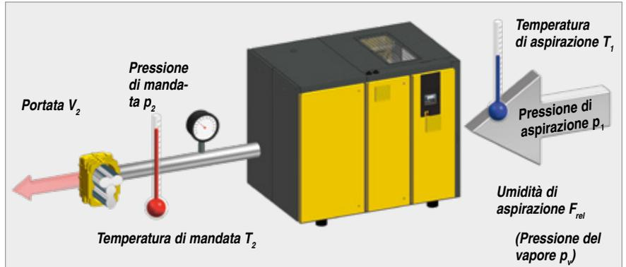
Fig. 1: Portata volumetrica conforme a ISO 1217, allegato C
