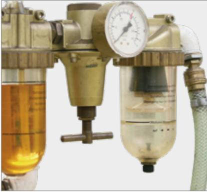
Fig. 6: Unità di manutenzione con riduttore di pressione
