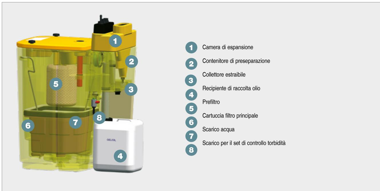
Fig. 3: Sistema di separazione gravitazionale della condensa (schema funzionale)
