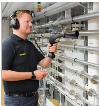
Fig. 4: Rilevamento perdite con ultrasuoni
