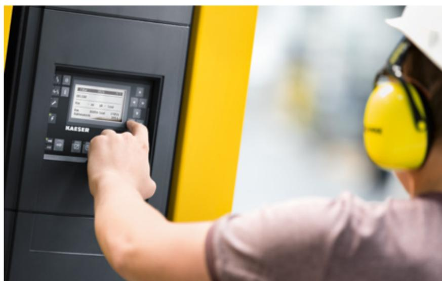
Dispositivi di controllo proporzionale con valvola a farfalla sul lato di aspirazione non sono raccomandati perché con una portata al 50 % il compressore consuma il 85 % dell'energia necessaria per il 100 % della portata.
